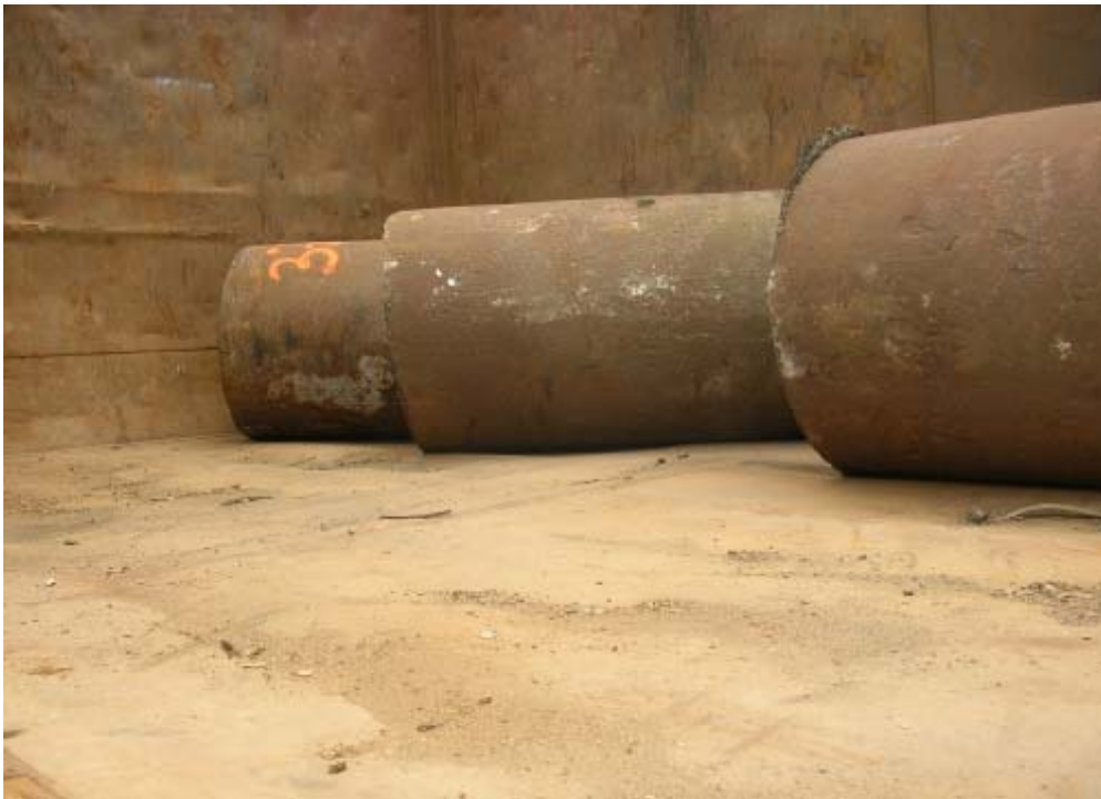
Verrollte Ladung (Ansicht in Fahrtrichtung)
