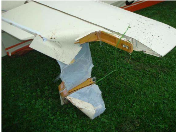
Beschädigung am rechten Höhenruder
