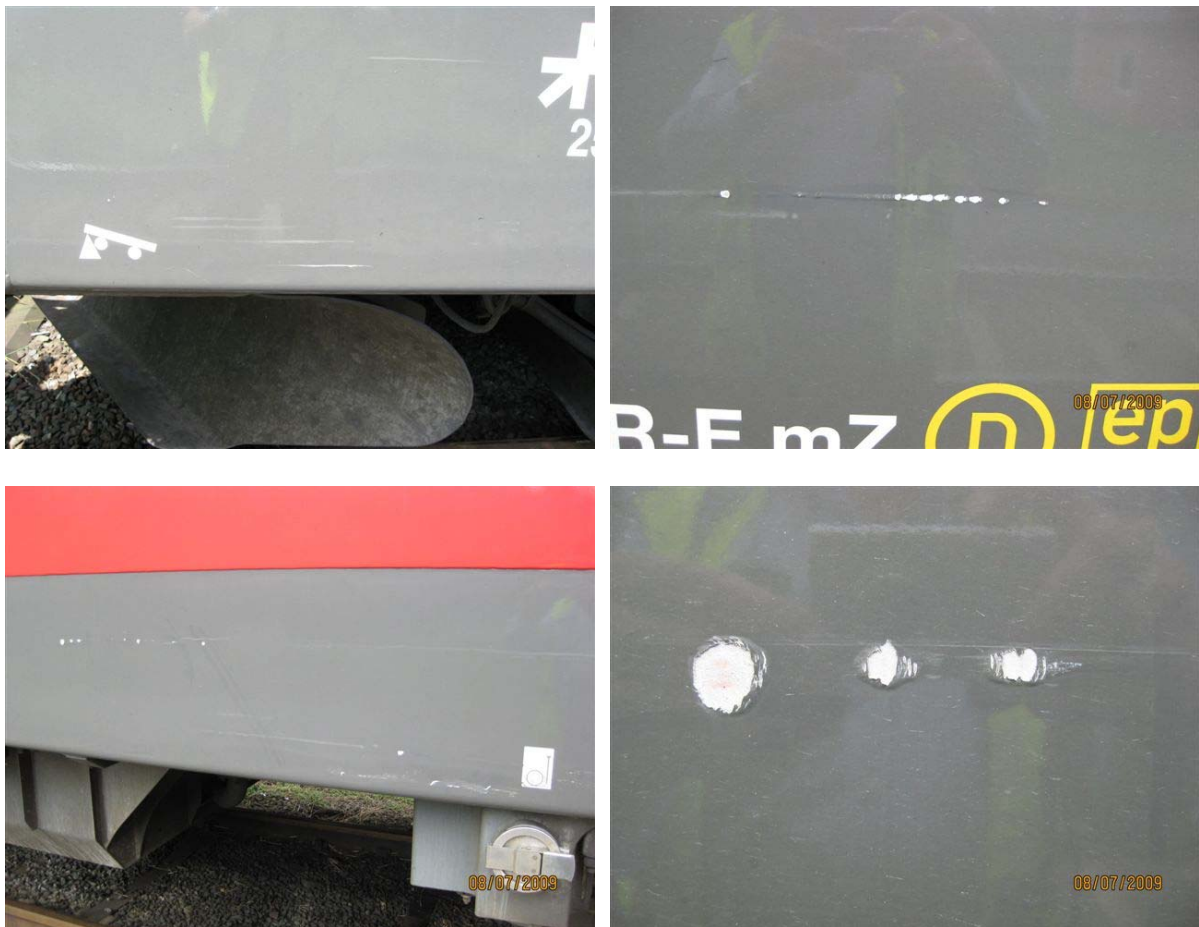
Abbildung 6 Schäden am Nachschiebe-Tfz 1216 141-0 - Quelle ÖBB
