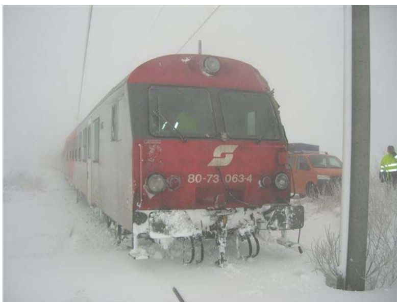
Abbildung 7 Beschädigter Steuerwagen - Quelle ÖBB
