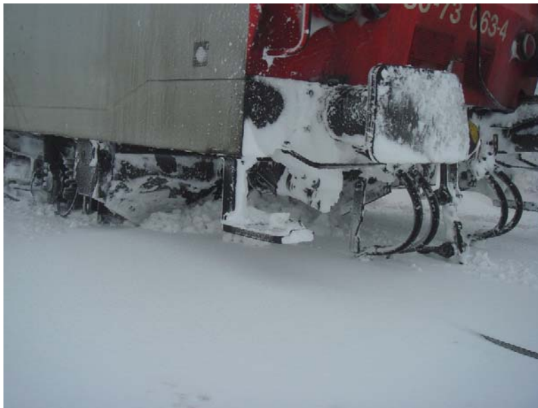
Abbildung 6 Verformter Bahnräumer des Steuerwagens - Quelle ÖBB
