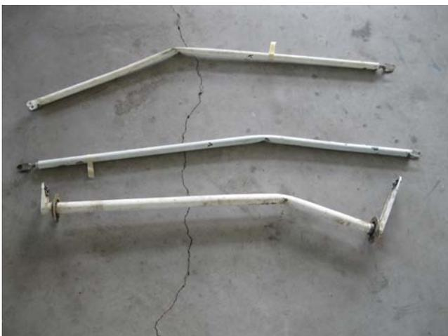
Hauptsteuerrohr und Schubstangen für Höhen- und Querruder deformiert
