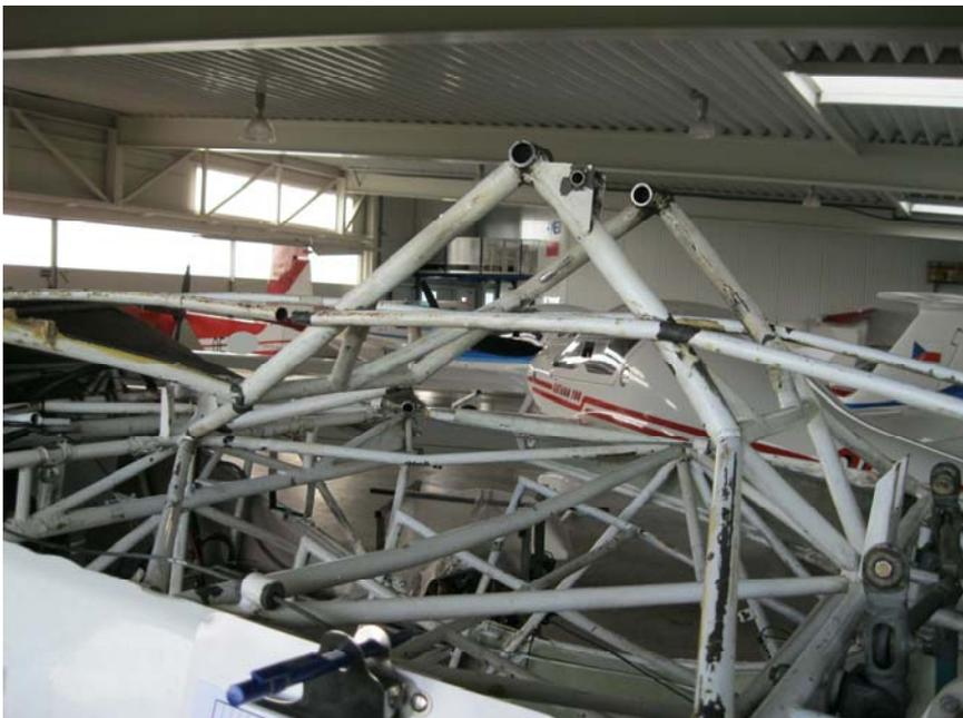
Stahlrohrgestütze des Hauptfahrwerks nach innen gestaucht
