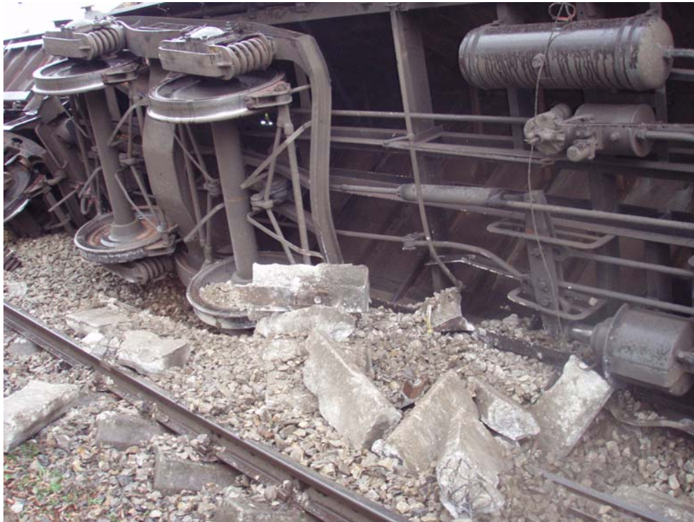
Abbildung 9 Zerstörte Zweiblockbetonschwellen und umgestürzter 18. Wagen
