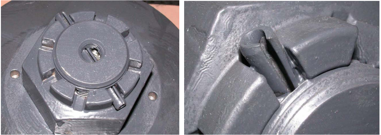
Abbildung 6 Kronenmutter und Spannstift im neuwertigen Anlieferungszustand (Quelle Gutachten)
